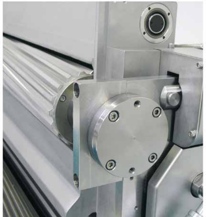
Wspornik łożyska na zewnątrz komory tnącej
