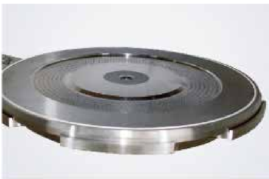
Płyta matrycy na podnośniku
