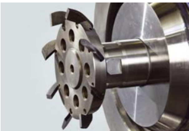
Głowica tnąca w SPHERO®
