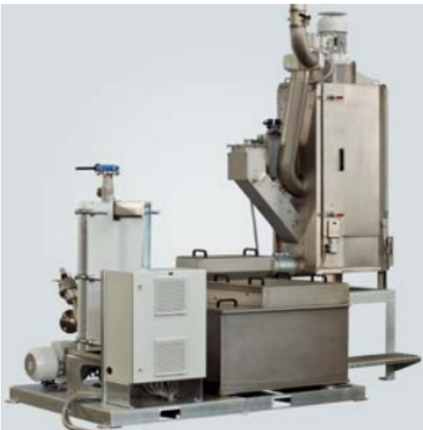
System uzdatniania wody procesowej PWS z suszarką wirówkową CENTRO
