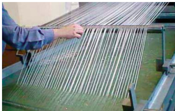
KW 600 koryto chłodzące do maksymalnie 60 nitek.
