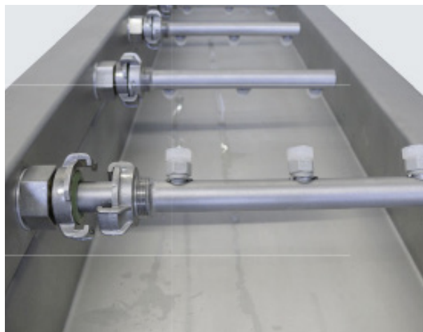
Możliwość szybkiej i łatwej wymiany rur natryskowych podczas pracy systemu
