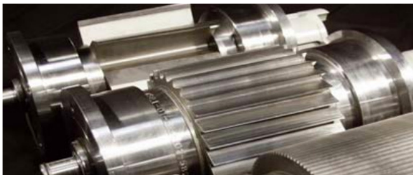
Wirniki tnące do produkcji mikropeletek (przód), wirnik standardowy (środek) i do produkcji długich włókien (LFT).
